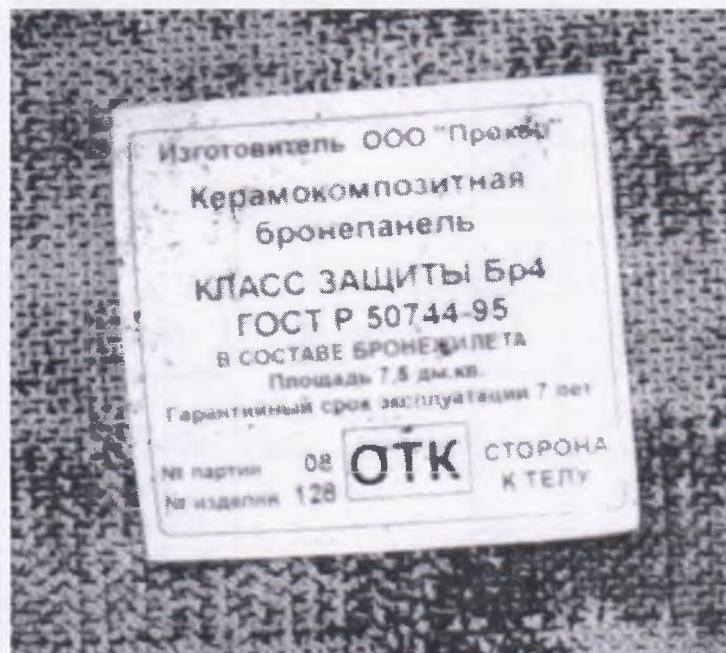
Рис. 1 Внешний вид а) маркировки бронесистемы «БРС-01» и б) маркировки керпакомпозитной бронепанели представлен на рисунке 1.
