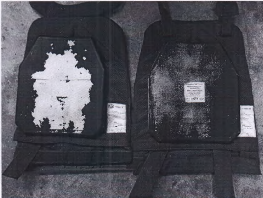
Рис. 4 Внешний вид элементов бронесистемы БРС-01 № 116000005 (после выдержки при температуре +40°С) после воздействия пяти пуль ПП патронов калибра 5,45x39 мм инд. 7Н10 и пяти пуль ПС патронов калибра 7,62x39 мм инд. 57-Н-231(ТУС).
